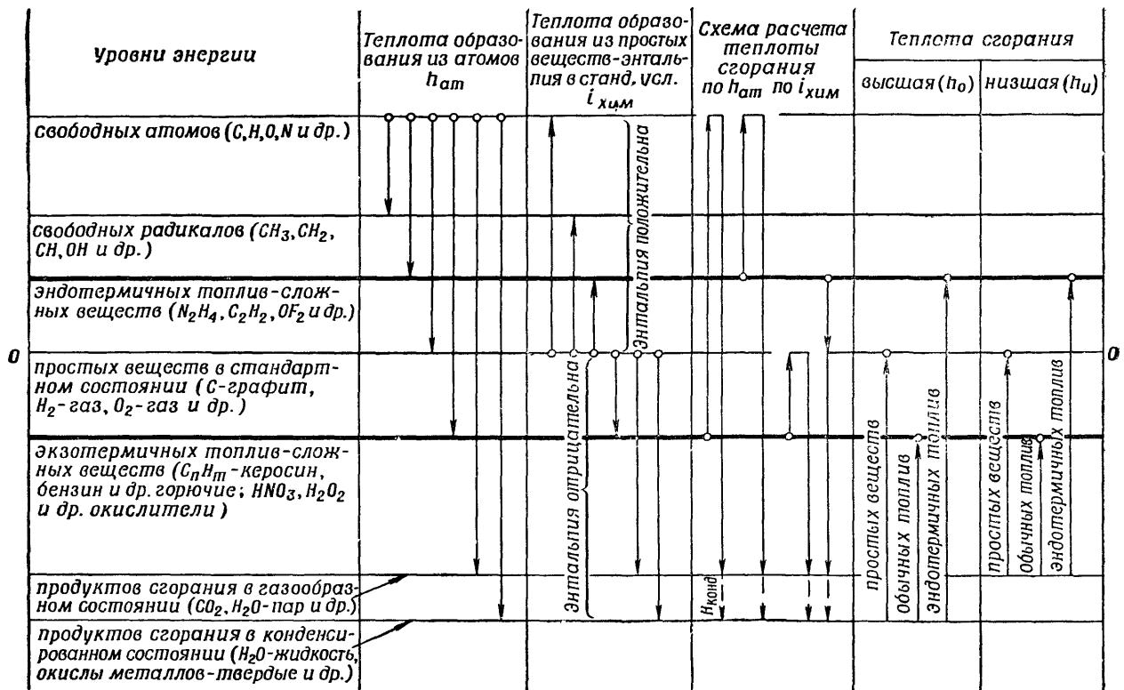
Рис. 3. Схема взаимосвязи теплоты образования, энталпии и теплотворности топлива (для условно изотермического процесса сгорания выделенное тепло является отводимым и имеет знак минус)
