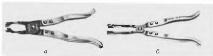
Рис. 3.2.6. Щипцы для снятия уплотнительных манжет клапанов: *а* — для двухклапанных двигателей; *б* — для многоклапанных двигателей
