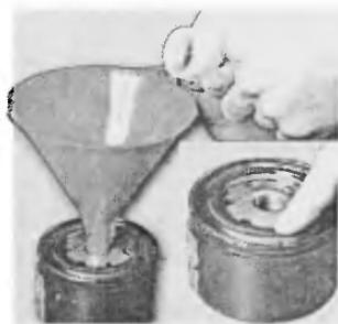
Рис. 1.4.4. Заливка масла в фильтр
